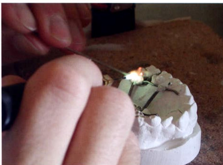
Foto2 – Saldatura a fiamma con apporto di saldame a base di argento
