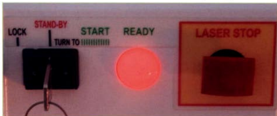
Foto 9 - Comandi di avvio e stop dell'apparecchiatura
